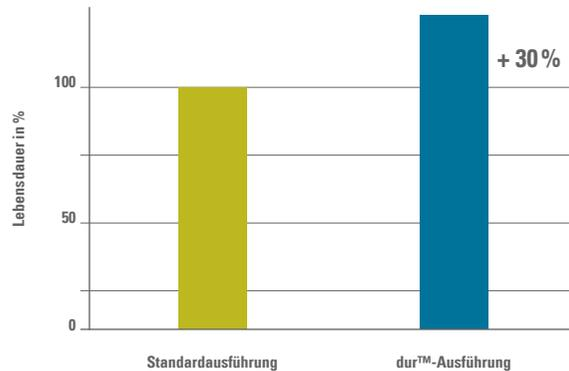
Diese wird jedoch erst durch eine Anpassung des Nadelwechselrhythmus optimal ausgeschöpft. Ist der Wechselrhythmus auf das neue Material eingestellt, verweilen die Nadeln um bis zu 30 % länger im Brett als das Standardmaterial. Dies hat zur Folge, dass die Produkteigenschaften ebenfalls über längere Zeit dieselben bleiben.
